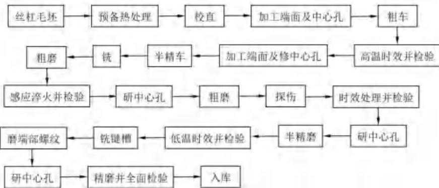
图：行星滚柱丝杠工艺流程图（螺母）
